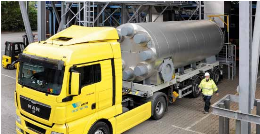
Abb. 1: Mobiler Sorptionswärmespeicher an der Ladestation (© MHB Hamm Betriebsgesellschaft). Fig. 1: Mobile sorption storage docking to the charging station (© MHB Hamm Betriebsgesellschaft).
