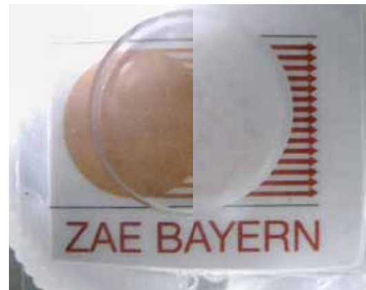
Abb. 2: Optisch schaltbares Nanomaterial (durch Einstellung der relativen Feuchte). Links im transparenten Zustand, rechts im opaken, stark streuenden Zustand.
