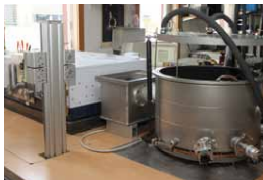
Abb. 4: FTIR-Spektrometer mit Emissionsgrad-Messanlage (Eigenentwicklung ZAE Bayern) zur Ermittlung infrarot-optischer Eigenschaften bei hohen Temperaturen (bis 1.600°C).
