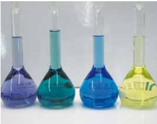
Abb. 1: Speichermedium der Redox-Flow-Batterie: Vanadium-Elektrolyt in seinen vier verschiedenen Oxidationsstufen.
