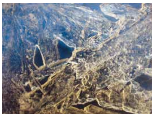
links: Abb. 4: REM-Aufnahme einer Stütze für Vakuumisolierverglasung - verhindert ein Kollabieren der Verglasung durch den Luftdruck.
