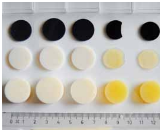
Abb. 1: Keramikartige nanoporöse Hybridgele bestehend aus organisch-anorganischen Komponenten und daraus abgeleitete infrarot-getrübte Aerogele (schwarze Scheibchen). Die Aerogele weisen eine gute mechanische Stabilität auf.
