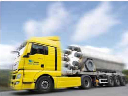
Abb. 3: Mobiler Zeolith-Speicher unterwegs (© MVA Hamm Betreiber GmbH).
