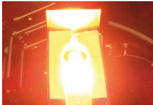
Abb. 2: Nahaufnahme einer Heizvorrichtung zur Bestimmung der Wärmeabstrahlung bei hohen Temperaturen.
