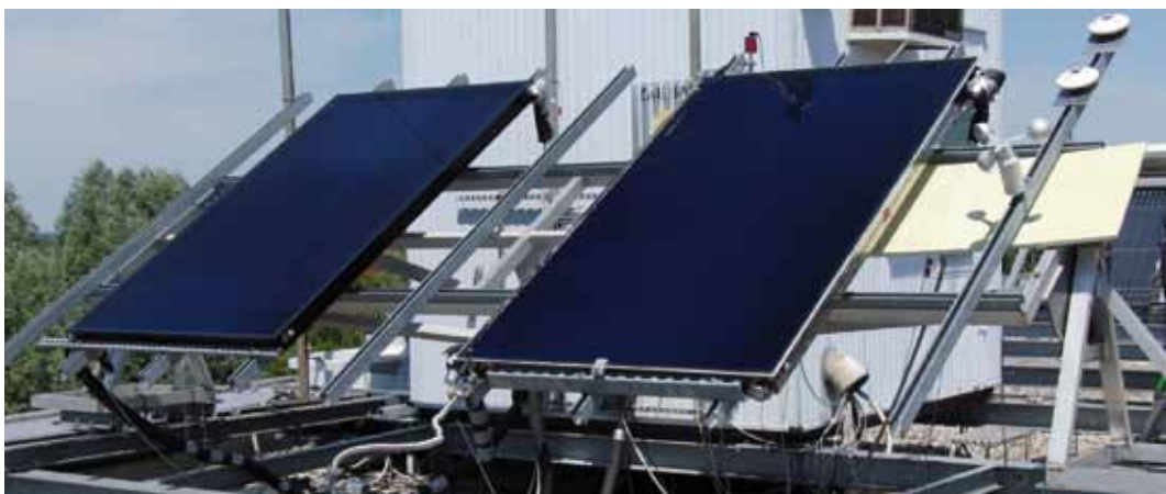
Abb. 3: Vermessung des Prototypen mit rückseitiger VSI-Dämmung (rechts) gegen den (bis auf die Rückseite) baugleichen Serienkollektor mit Mineralwolldämmung (links) auf dem Freiluftteststand des ZAE Bayern.
