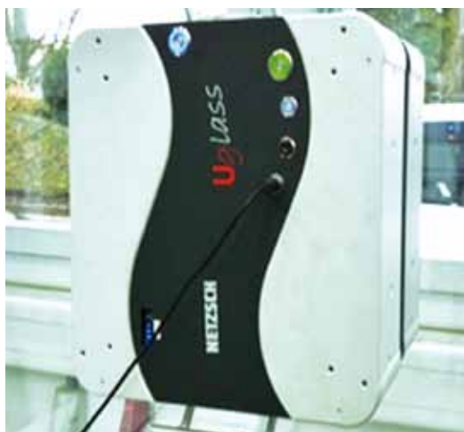
Abb. 1: Messgerät zur Bestimmung des U_g -Wertes von Bestandsverglasungen.
