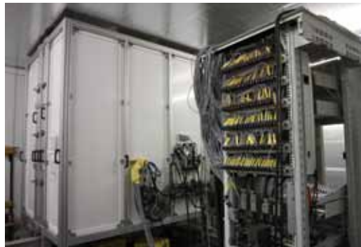
Abb. 3: Hot Box Apparatur zur Bestimmung des Wärmedurchgangskoeffizienten (U-Wert) von Fassadenelementen und Wärmedämmsystemen. Dieses Messverfahren ist auch für inhomogene Proben (z. B. komplettes Fenster aus Verglasung plus Rahmen; Türen mit Rahmen) geeignet.
