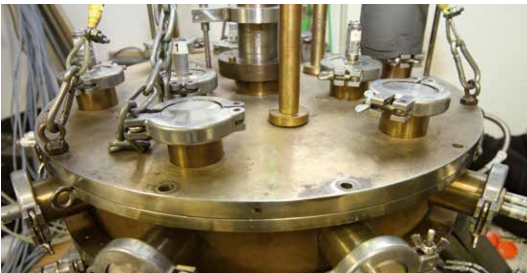
Abb. 3: Plattenapparatur zur Messung der Wärmeleitfähigkeit in geschlossenem Zustand. Die Charakterisierung kann bei Temperaturen zwischen -200°C und 800°C unter Vakuum und verschiedenen Atmosphären erfolgen.
