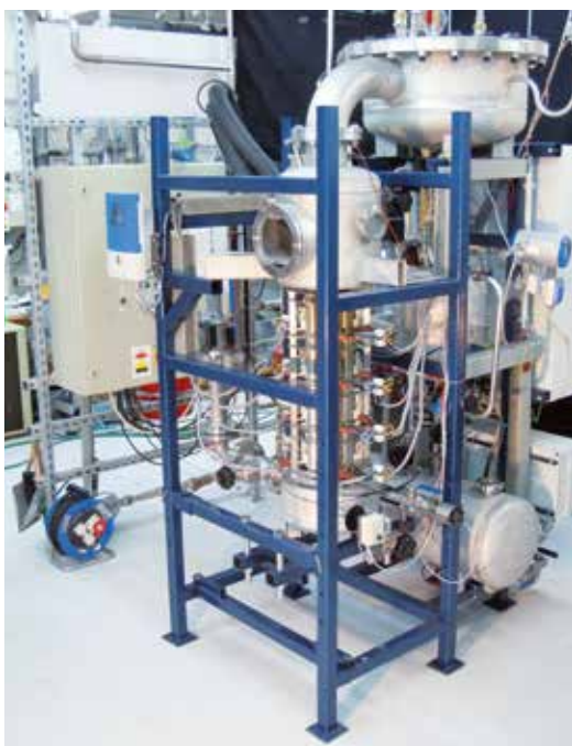
Abb. 2: Versuchstand zur experimentellen Ermittlung thermo- und fluiddynamischer Charakteristika in einem stehenden Siederrohr für Hochtemperaturaustreiber mehrstufiger Absorptionskältemaschinen.
