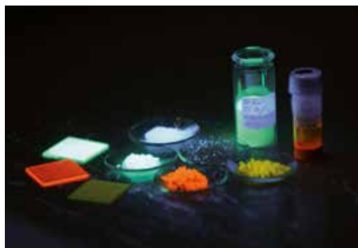
Abb. 4: Fluoreszierende Pulver und Lösungen sowie beschichtete Glassubstrate mit Quantenpunkten und Polymer. Fig. 4: Fluorescent powder and solutions as well as coated glass substrates with quantum dots and polymer.
