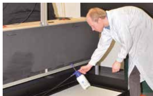
Abb. 4: Beim Isolationstest unter Benässung wird das Solarmodul in die Prüflösung gelegt und damit von allen Seiten eingesprüht.
