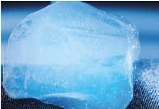
Abb. 1: Silica-Aerogel ohne mechanische Verstärkung (hier) ist zu fragil für bautechnische Anwendungen. Im Projekt AEROCOINs wird u.a. Cellulose zur Verstärkung der anorganischen Aerogel-Komponente eingesetzt.
