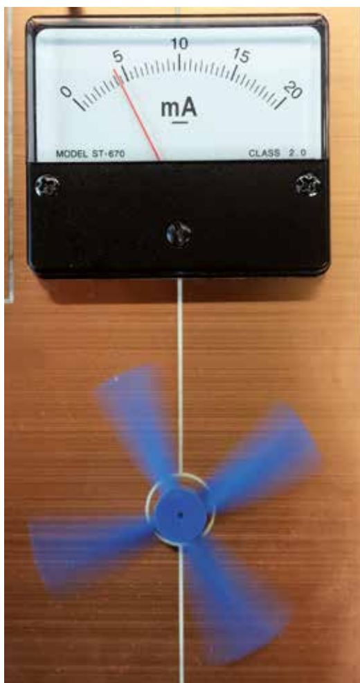
Abb. 1: Demoaufbau (Ausschnitt) zur Kopplung organischer Solarzellen (Energiewandler) und Superkondensator (schneller Energiespeicher). Auch ohne Sonneneinstrahlung liefert der Speicher genügend Energie zum Betrieb des Ventilators.
