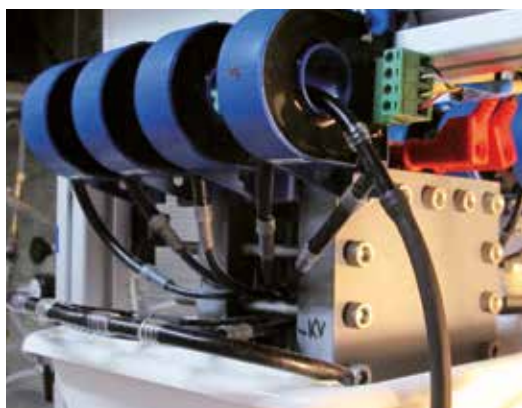
Abb. 1: Mini-Stack einer Vanadium Flussbatterie mit 5 Zellen. Fig. 1: Mini stack of a vanadium flow battery with 5 cells.
