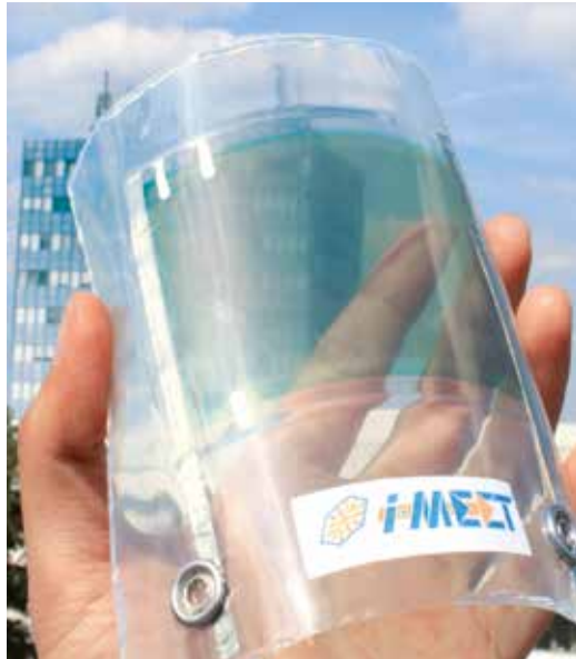
Abb. 6: Beim Materialica Design + Technologie Award 2013 mit Gold ausgezeichnet: Vollständig gedrucktes, semitransparentes organisches Solarmodul
