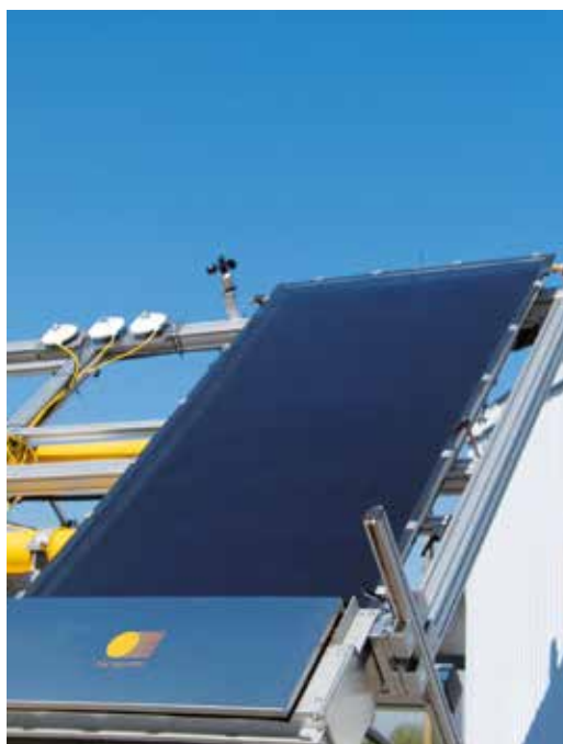
Abb. 3: Prototyp eines VSI-gedämmten Flachkollektors zur Prozesswärmeerzeugung auf dem Freiluftteststand des ZAE Bayern (VSI: Vakuum Superinsolation).
