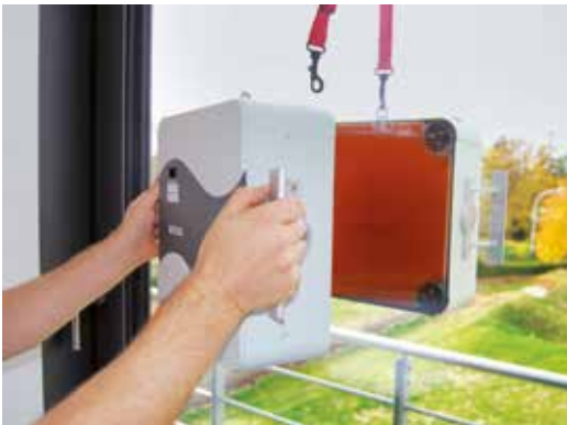
Abb. 1: Mobiles U_g -Wert-Messgerät zur thermischen Charakterisierung von Bestandsverglasungen.
