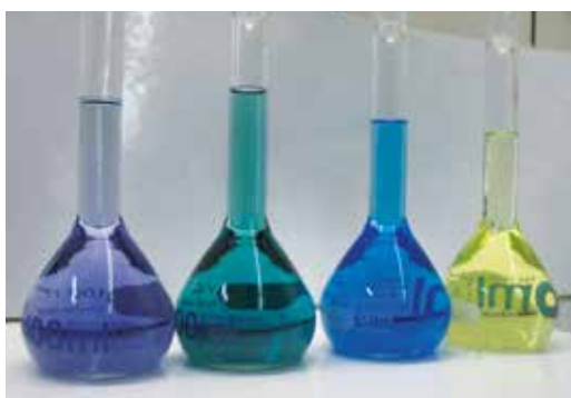
Abb. 2: Ein hoher Anteil an fluktuierenden Erneuerbaren Quellen erfordert die Integration weiterer flexibel steuerbarer Systemkomponenten wie z.B. elektrochemische Speicher (hier Elektrolyte zyklens-fester Redox-Flussbatterien, die u.a. am ZAE Bayern weiterentwickelt werden).
