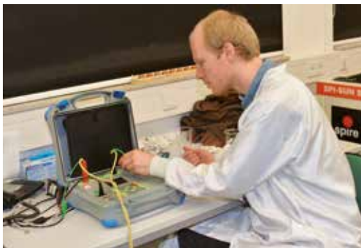
Abb. 1: Beim Isolationstest unter Benässung wird das zu prüfende Modul mit bis zu 1000 V beaufschlagt.
