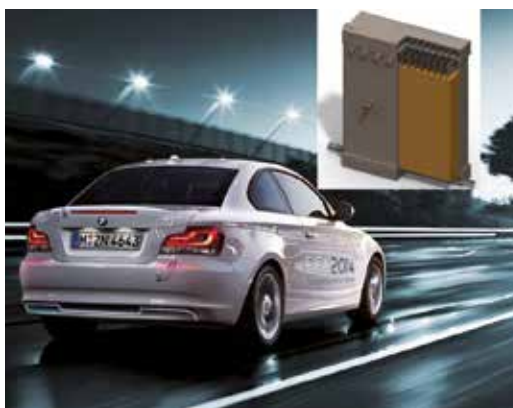
Abb. 2: Im Projekt „Energieeffizientes Fahren 2014 - EFA 2014/2“ entwickelter Latentwärmespeicher für einen BMW ActiveE (© BMW Group). Fig. 2: Latent heat storage for a BMW ActiveE developed in the project „Energieeffizientes Fahren 2014 – EFA 2014/2“ (Energy Efficient Driving 2014) (© BMW Group).
