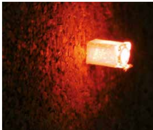
Abb. 2: Oxidationsprozesse an einer gesinterten Tantalprobe.
