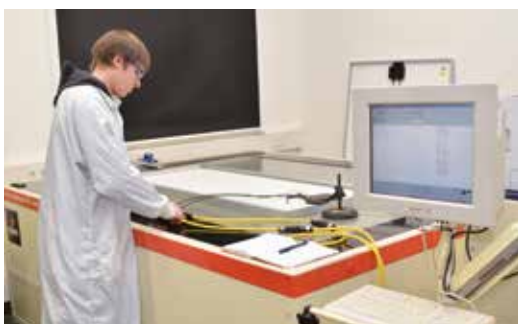
Abb. 3: Am Sonnensimulator kann die Leistung von Solarmodulen aller gängigen Größen normkonform gemessen werden.
