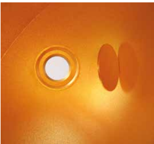
Abb. 3: Innenansicht einer Ulbrichtkugel (erzeugt ein homogenes Strahlungsfeldes) zur Bestimmung der infrarot-optischen Eigenschaften.
