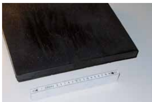
Abb. 2: Nanoporöser Kohlenstoff-Komposit (Platte ca. 30x30 cm 2 ) mit einer Wärmeleitfähigkeit von 0,1 bis 0,2 W/mK bei Temperaturen > 2000°C und damit hervorragend als Hochtemperaturwärmedämmung geeignet.
