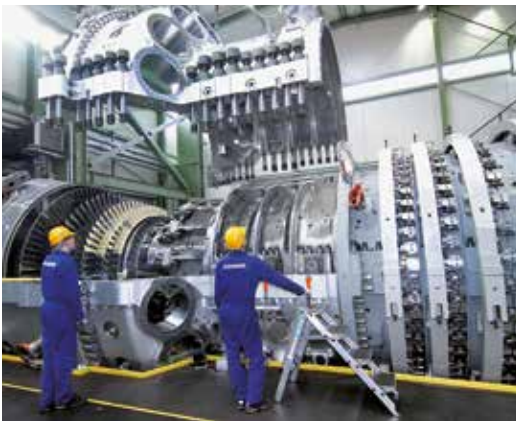
Abb. 1: Montagearbeiten an einer Gasturbine der Firma Siemens (© Siemens AG).
