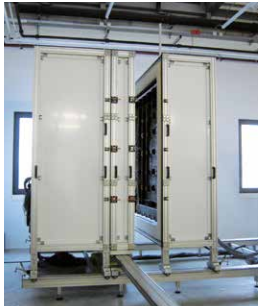
Abb. 2: Hot-Box zur thermischen Charakterisierung kompletter Fenstersysteme (Verglasung plus Rahmen).
