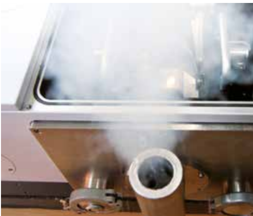
Abb. 1: FTIR-Spektrometer zur Bestimmung des Strahlungstransports bei kryogenen Temperaturen.
