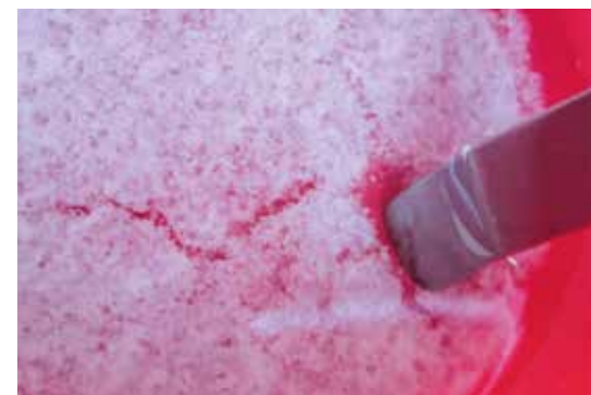
Abb. 1: Schmelzversuch einer PCM-Probe. Die feste Phase schwimmt nicht wie bei Wassereis auf der Flüssigkeit
