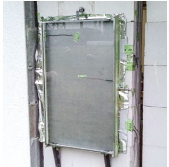
Abb. 1: Wandelement mit integriertem schaltbarem Vakuumisulationspaneel
