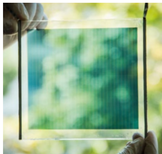
Abb. 1: Foto eines semitransparenten OPV-Moduls hergestellt am ZAE-Technikum Solarfabrik der Zukunft
