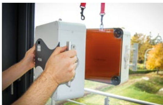
Abb. 13: Mobiles Ug-Wert-Messgerät Uglass im Einsatz (©ZAE Bayern) Fig. 13: Mobile measuring unit Uglass at work (©ZAE Bayern)
