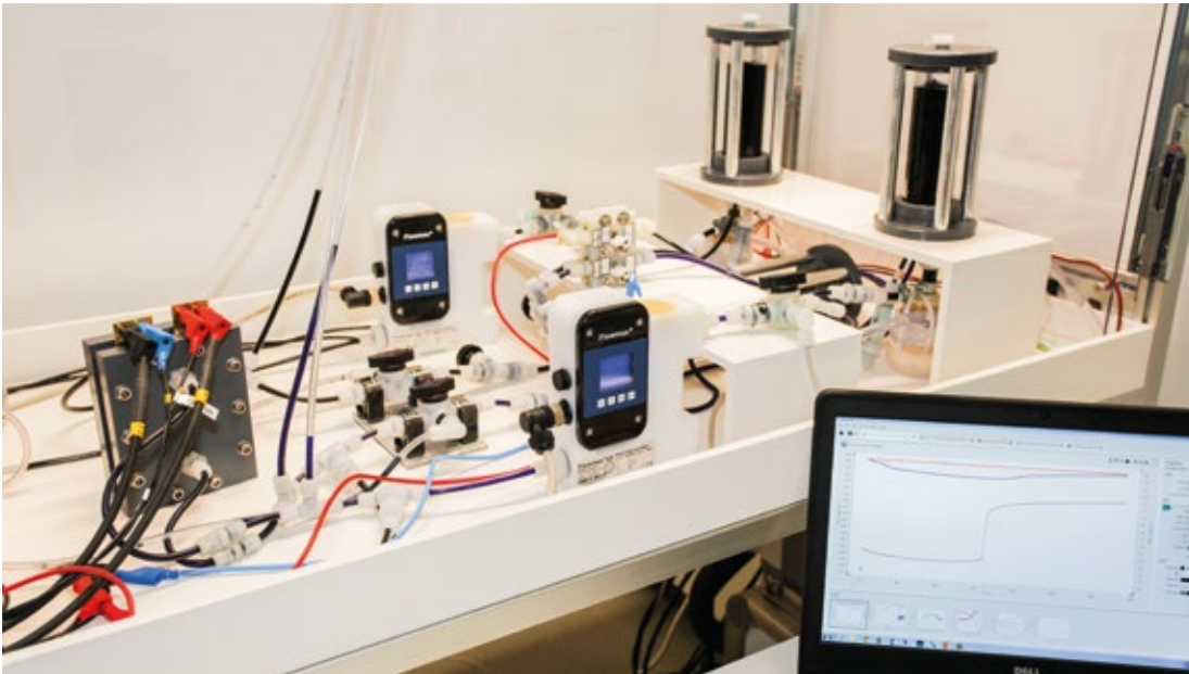
Abb. 2: Testumgebung zur Vermessung von Redox-Flow-Einzellen Fig. 2: Testing rig for the measuring of redox flow cells
