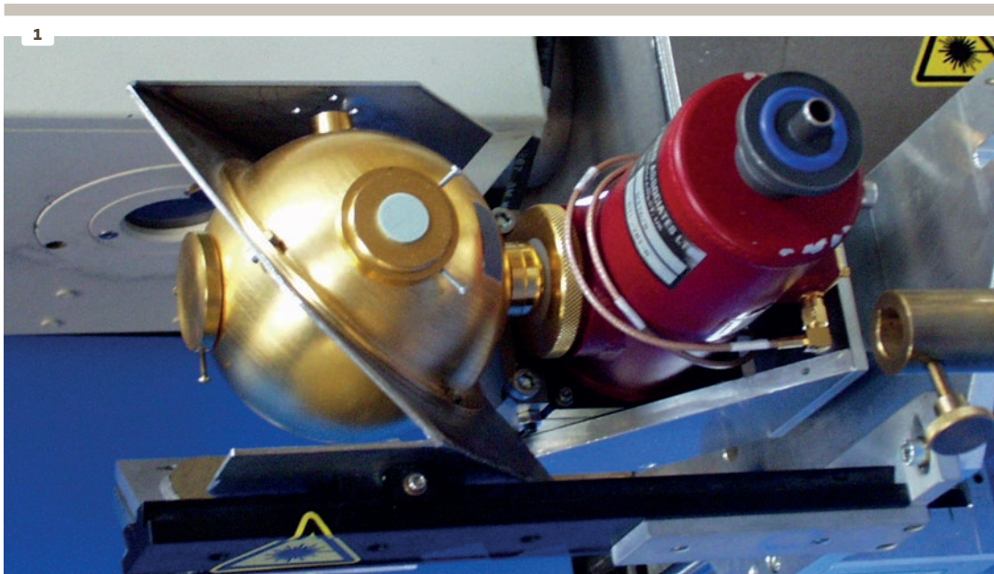
Abb. 1: Messaufbau bestehend aus Ulbrichtkugel (links) und Infrarotdetektor (rechts) zur Bestimmung von Reflexions-, Transmissions- und Emissionsgrad bei Raumtemperatur mittels eines FTIR-Spektrometers
