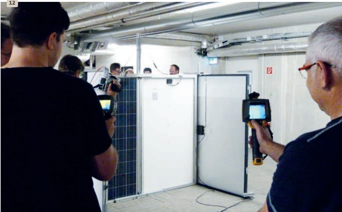
Abb. 12: PV-Gutachter untersuchen Solarmodule mit Infrarot-Thermografie. © ZAE Bayern
