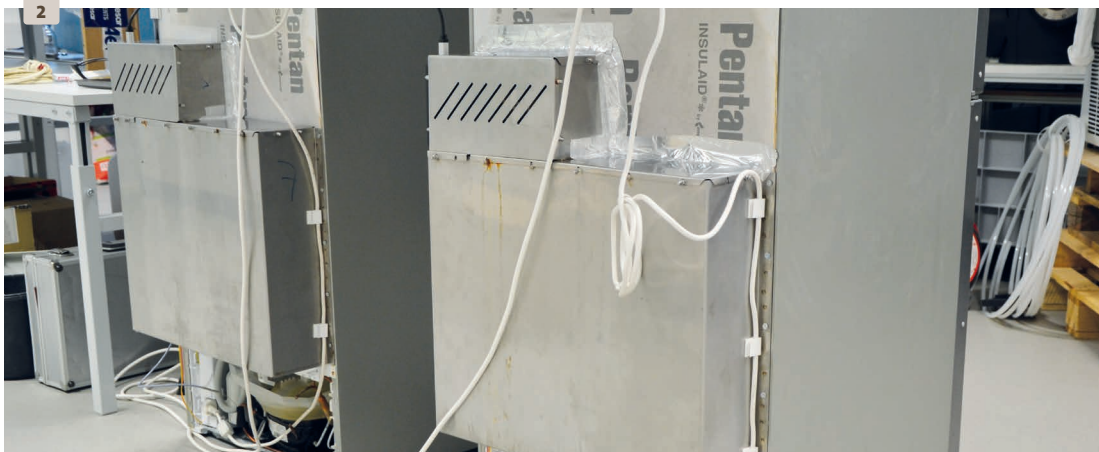
Abb. 2: Das im Projekt SolarSplit erfolgreich getestete Kühlsystem mit Latentwärmespeicher
