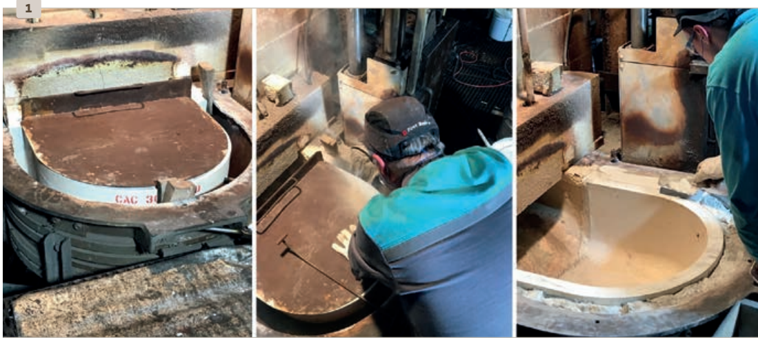
Abb. 1: Neuartige Dämmung mit getrübbtem Perlitpulver im Ringspalt eines Glasfeeders
