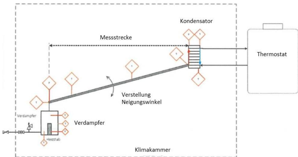
Abbildung 1: Prüfstandsskizze Entrainmentlimit
