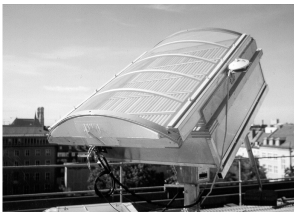
Bild 1: Versuchsaufbau zur g-Wert-Messung
