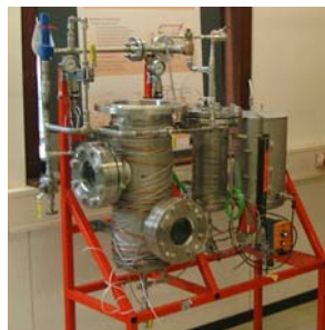
Abb. 2. 2: Korrosionsteststand (vor Isolierung)
