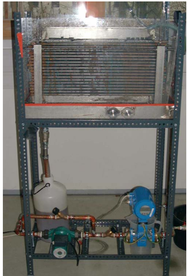
Abb. 2.1.8: Laboraufbau zum Test von Lösungsaufgabesystemen
