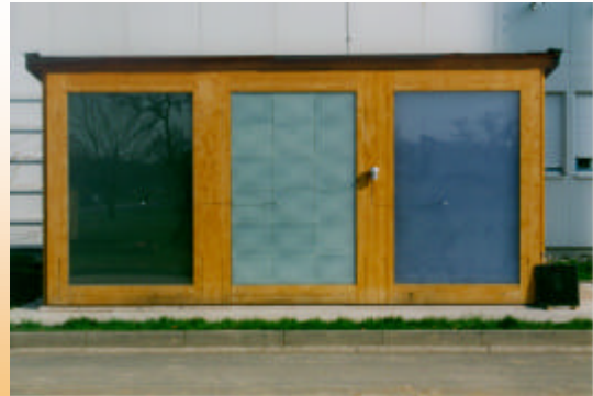
Abb. 3: Messung von Wärmeströmen und Temperaturen. Links: konventionelles System. Mitte: perlglanzbeschichtete Abdeckung. Rechts: farbiger Absorber und low-e-beschichtete Scheibe.
